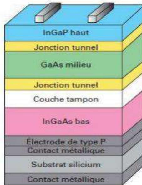
Figure III.5 : vue schématique de la composition de la cellule à multi jonction.
